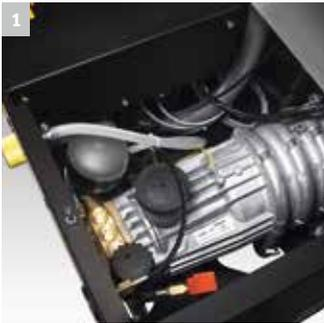
1 水冷四极电机（燃油加热）
