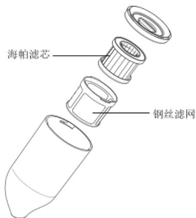
**特别注意：**海帕冲洗后请务必彻底晾干后方可装入吸器内使用；为保持产品处于良好的工作状态，建议定期清洁滤芯；如产品使用频次较高，建议使用6个月后更换滤芯。滤网的材质为SUS304不锈钢，冲洗后晾干即可使用。
