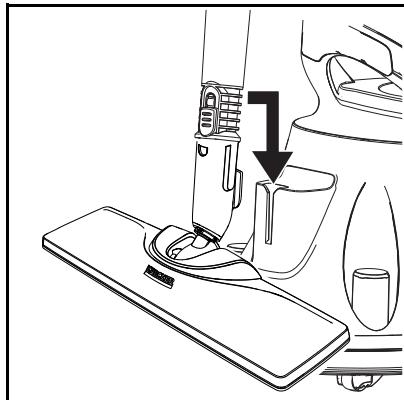
2. 将蒸汽软管和电源线缠绕在手柄或设备上，和/或将蒸汽喷枪插入地面扒头中。
