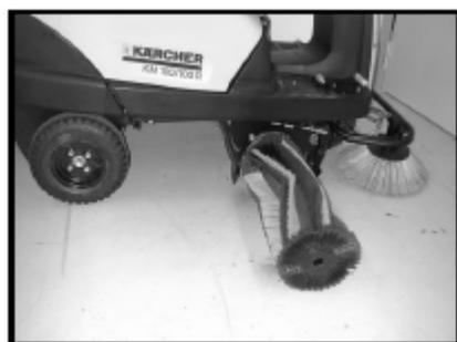
▶将主刷正确安装在驱动标度钉上。
